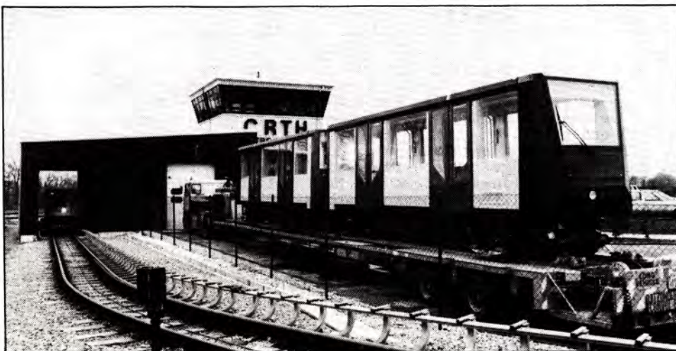
Het nieuwe TAU - prototype (in de Belgische kleuren uitgevoerd) komt, met de NMVB-transportwagen, aan op het testcircuit te Jumet. Links staat het labovoertuig 01-02. 26.03.85
