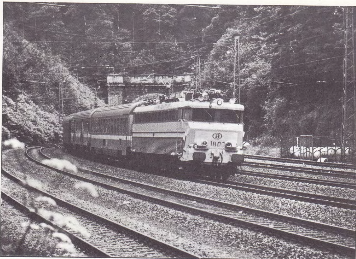
HIE 1806 (Alsthom - BN, 1973) sleept met zijn 3420 kW trein 321 Oostende - Köln-Hbf. Aachen-Süd, 05.08.83, foto Antoon Hermans.
